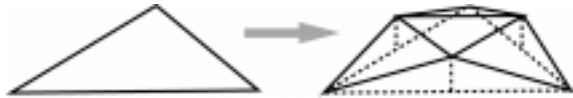
図 11: 3次元フラクタルノイズ: 左の三角形が、各エッジを分割して4枚に分割される。この手順が繰り返される。
